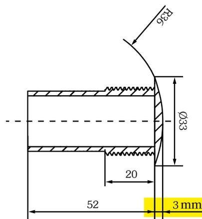
Grazie all'ampio angolo di apertura è garantito un funzionamento sicuro anche con scostamenti dall'angolo dovuti al montaggio. Il modello M25 è conforme alle dimensioni standardizzate dei pressacavi. Il tipo di protezione elevato della struttura dell'alloggiamento è conservato per mezzo del montaggio di una guarnizione di tenuta.
