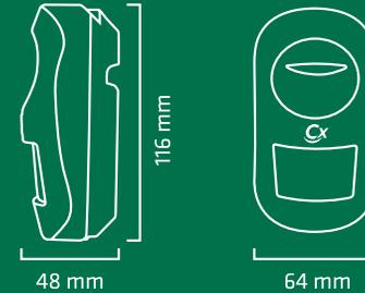
I rivelatori della serie Tauro possono essere installati **direttamente a parete** (con montaggio **frontale** o a **45°**) o utilizzando l'apposito **snodo** (non fornito in dotazione) per l'**installazione a soffitto** o a parete.
