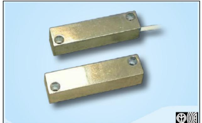
Contatto magnetico da superficie in alluminio per serramenti ferromagnetici. Note per l'installazione: allineare come da disegno, fissaggio con viti, tappi coprivite a pressione e viti forniti di serie. Dove possibile si raccomanda di installare alla distanza di 5mm in linea con l'asse principale Y.
